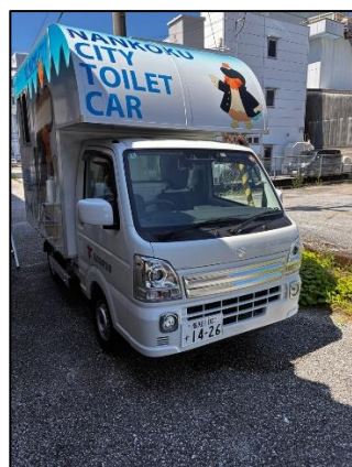
6. 車載トイ レ (トイレカー) ※南国市 ※設置して いるトイレ は貯留型で なくラップ 式トイレ
