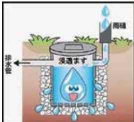
雨水浸透ます
