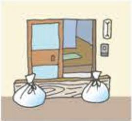
長めの板と土のうで臨時の止水板が作れます。
